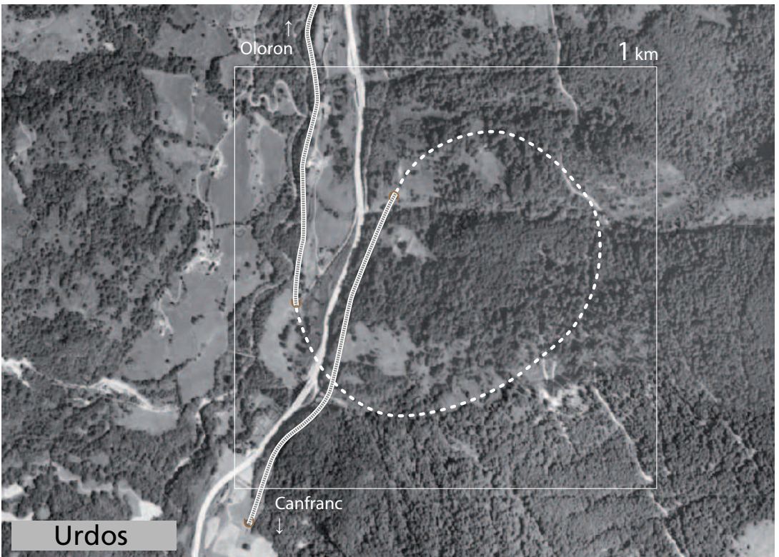
Vista punteada del túnel helicoidal de Sayerce en Urdos, sea una ganancia de 60,5 m en los 1830 m (3,3 %).
